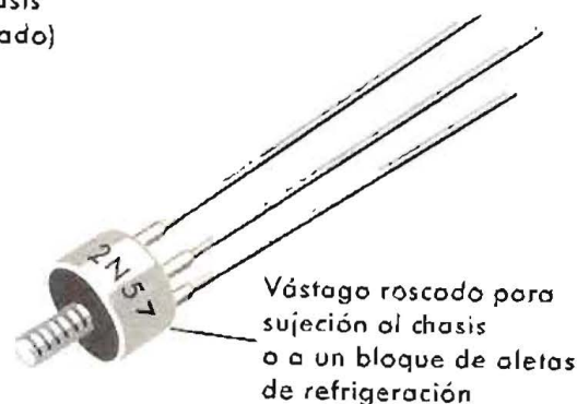
TIPO ADECUADO PARA ROSCARLO A UN BLOQUE REFRIGERADOR
