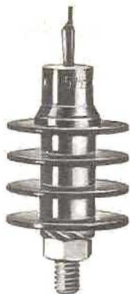
Diodo de silicio de potencia con aletas de enfriamiento incorporadas.
