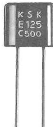
Pequeño diodo de silicio bajo capsula de plástico.
