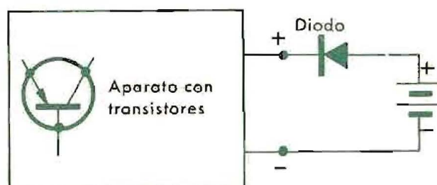
Alimentación con diodo protector automático contra la inversión de polaridad de la batería de alimentación.
