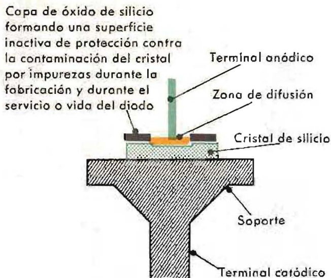
Estructura del diodo semiconductor de silicio del tipo de unión por difusión planar-epitaxial.
